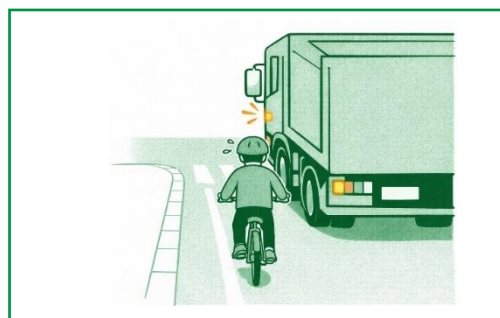
図4：左折事故 （左折する車が内輪差で自転車を巻き込む事故）
