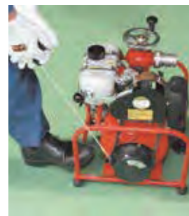
② ポンプのエンジンを始動し、吸水レバーを操作し、吸水します。
