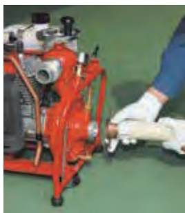
① 吸管を吸水口に結合した後、水源に吸管の先を入れます。
