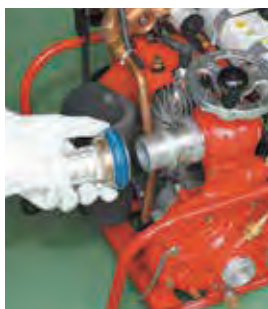
③ 放水を担当する人は、放水口・ホース・筒先を結合し、火元までホースを伸ばし、ポンプを操作する人に放水の準備ができた合図をします。
