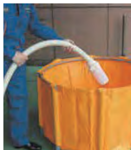
① 吸管を吸水口に結合した後、水源に吸管の先を入れます。
