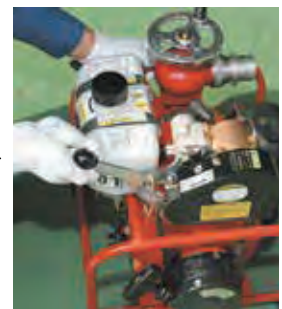
② ポンプのエンジンを始動し、吸水レバーを操作し、吸水します。
