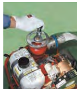
④ 筒先を持った人から合図があったら、放水弁ハンドルを開き放水します。水圧による反動力でバランスを崩さないよう、放水が終わるまでしっかりと保持します。
