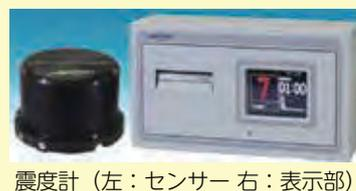
震度計（左：センサー 右：表示部）
